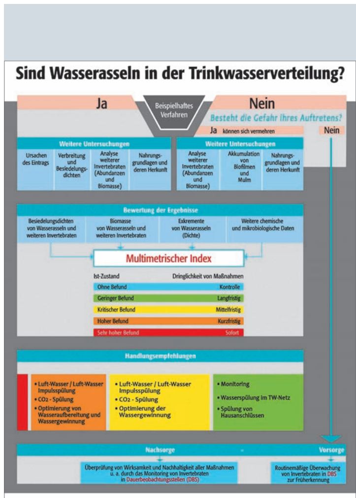
BILD 9: Schematische Darstellung des Bewertungsverfahrens von Invertebraten in Trinkwasser-Verteilungssystemen mittels eines Multimetrischen Index
